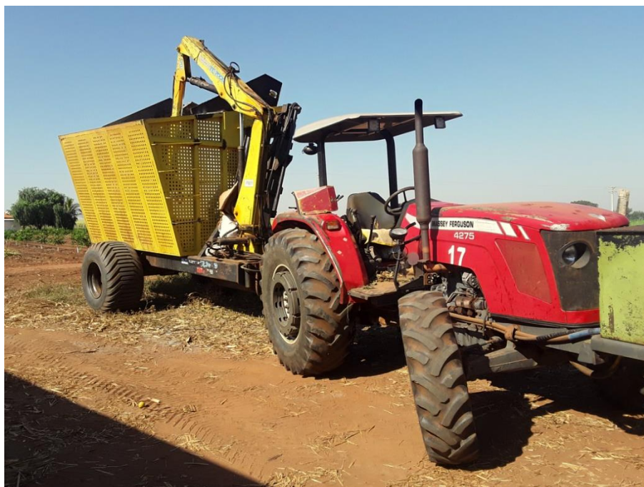
Figura 17: Equipamento hidráulico adaptado em trator agrícola
